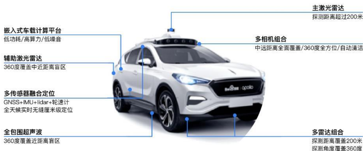
图 14 百度无人驾驶出租车硬件设备介绍
